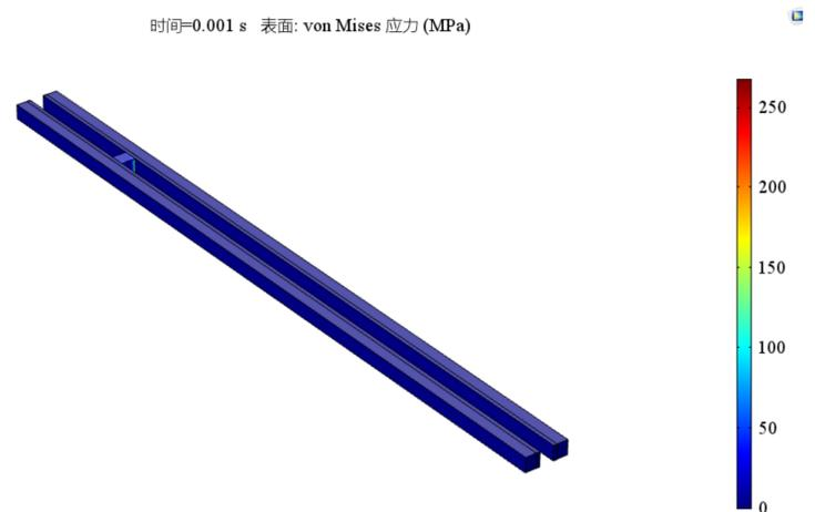
图 2. 复合轨道的整体受力
